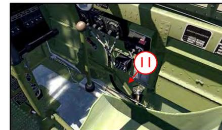
散热器控制杆 - 座舱壁(右)
